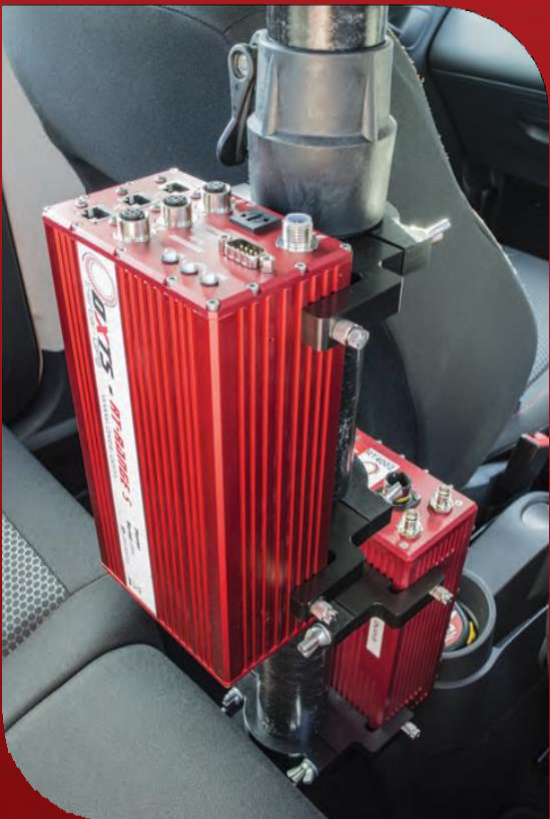
System nawigacji inercyjnej RT-Range S oraz RT zamontowany na statywie RT-Strut
