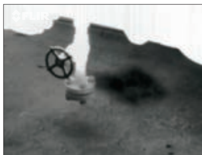
Wyciek metanu w zakładzie przetwórstwa gazu ziemnego
